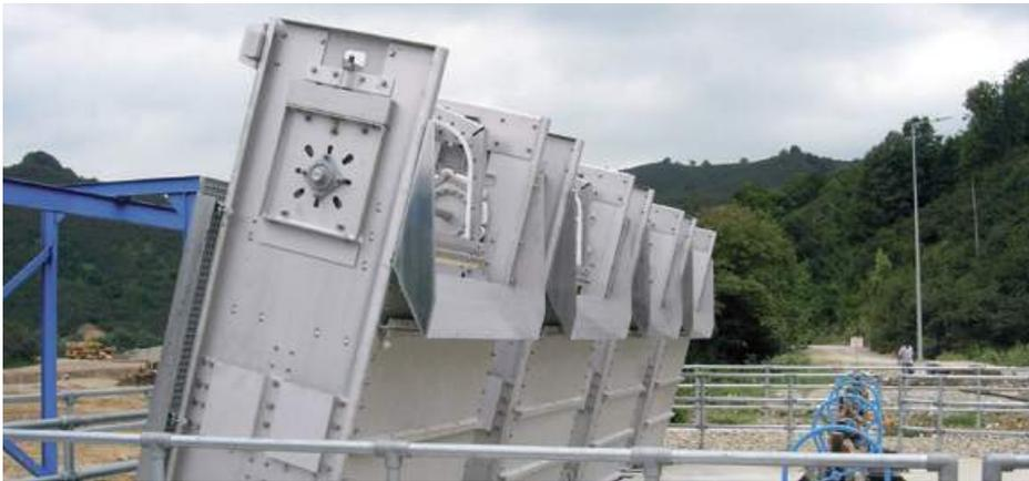
Dank der verschiedenen Reinigungselemente kann er für Sonderaufgaben, wie zum Beispiel das Wegführen von Quallen, Seegras und Fischen, eingesetzt werden. Die einfache Konstruktion verbunden mit modernen Design- und Fertigungsmethoden garantieren eine hohe Zuverlässigkeit und eine lange Nutzungsdauer dank geringer Wartungsanforderungen. Die in Deutschland gefertigten Maschinen eignen sich sowohl als Ersatz/Upgrade als auch für neue Anlagen.
