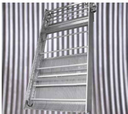
Dies begründet sich nicht nur im Einsatz von strömungsgünstigen Rechenstabprofilen in Abhängigkeit der hydraulischen Anforderungen, sondern auch in der variablen Anpassung seiner Reinigungselemente. Diese können je nach Transportaufgabe, in Typ und Anzahl, an die entsprechende Aufgabenstellung und den gewünschten Räumzyklus angepasst werden.
