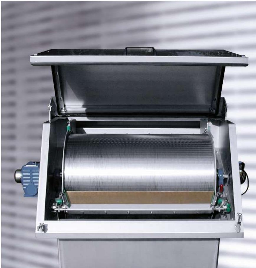
Die Aqseptence Group verfügt mit dem Noggerath® Trommelsieb RSH-E über ein kontinuierlich arbeitendes Siebsystem mit automatischer Reinigungseinrichtung. Das bewährte System trennt zuverlässig schwimmende, fettige und klebrige Feststoffe ab. Das Prozess- oder Abwasser wird rückseitig über die Zulaufkammer auf die horizontale Spaltsiebtrummel geleitet, wo der Feststoffanteil effektiv abgetrennt wird.
