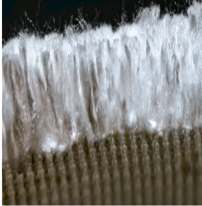
Polstofftuch aus Polyamid auf Polystergewebe
