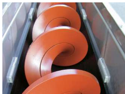
Spirale geführt in PE-UHMW Verschleißfutter
