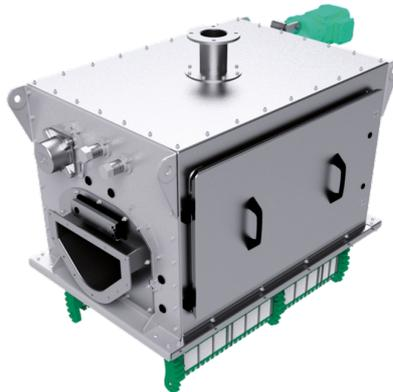
Modulares Kopfteil für bessere Siebbandreinigung, Sicherheit und Sichtung. Der Kopf umfasst das Antriebssystem, die Schwemrinne und das Spritzwassersystem mit Düsen für maximale Reinigungseffizienz. Vielseitige Optionen der Klappdeckel aus Edelstahl oder Plexiglas für mehr Sichtbarkeit. Wahlweise mit zusätzlichem Eingreifschutz-Gitter.
