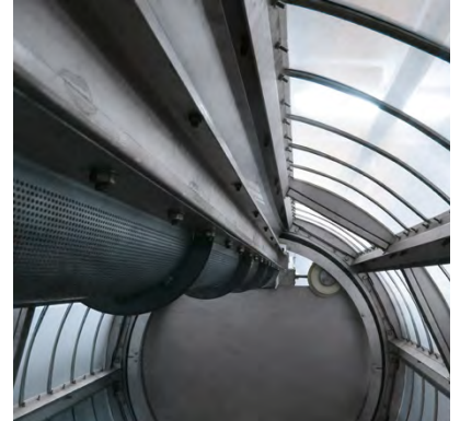
horizontal gelagerte Siebtrommel und interne Siehzone (hier als Lochblech)
