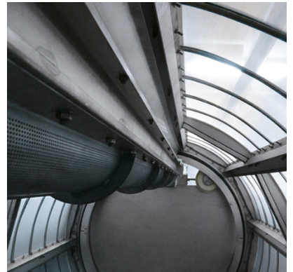
horizontal gelagerte Siebtrommel und interne Siehzone (hier als Lochblech)
