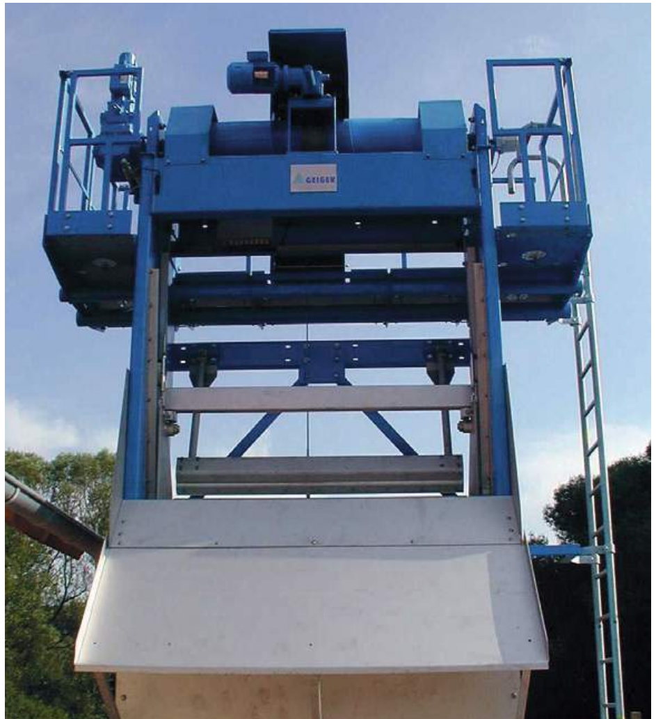
Passavant®/Geiger® stationärer Schalen- greiferrechen mit Wartungsplattform
